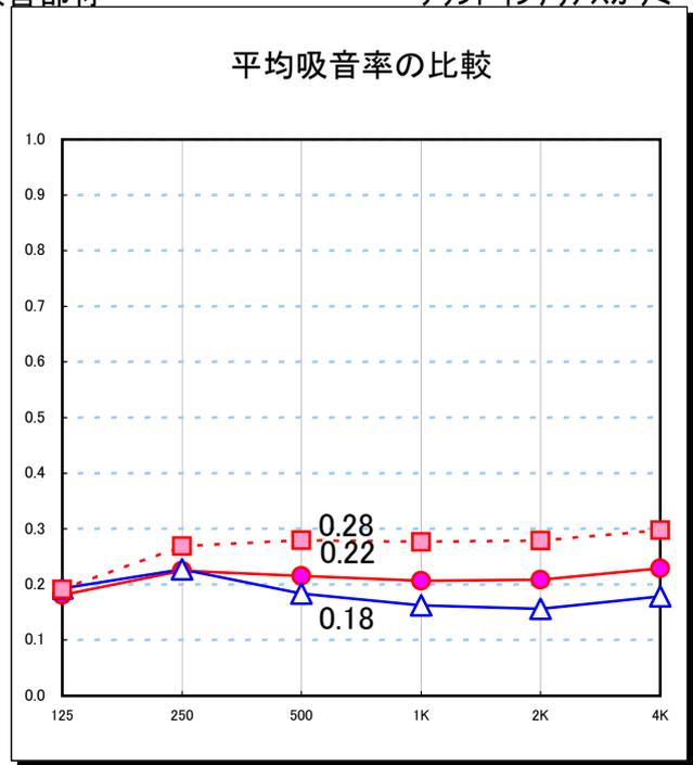
2.5×3.4×2.4の6帖弱の部屋に、テラス窓・ドアが各1ヶ所。壁はヤマハネラボード(Q/V)を配置。移動式散乱吸音体を2ヶ使用の場合です。
