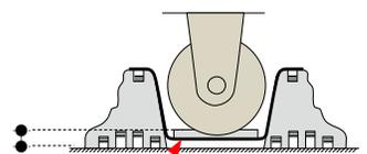
金属カップと床の間に空気の間隙があるため、振動が床に伝わりにくい
